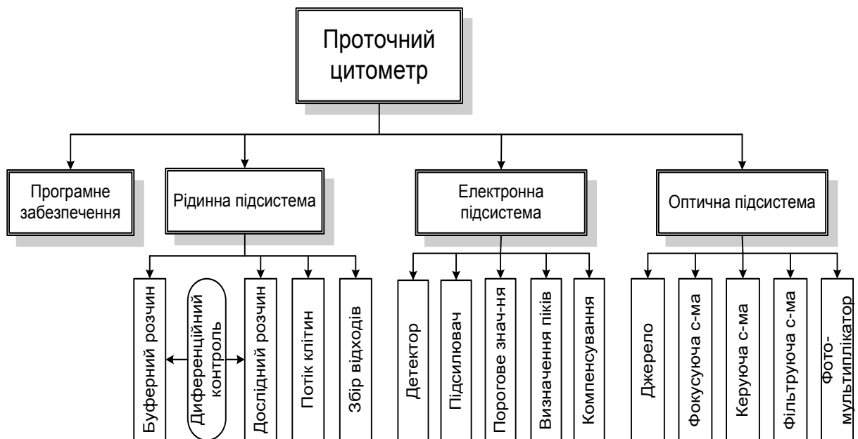
Рис. 1.9. Загальна структура проточного цитометра.
