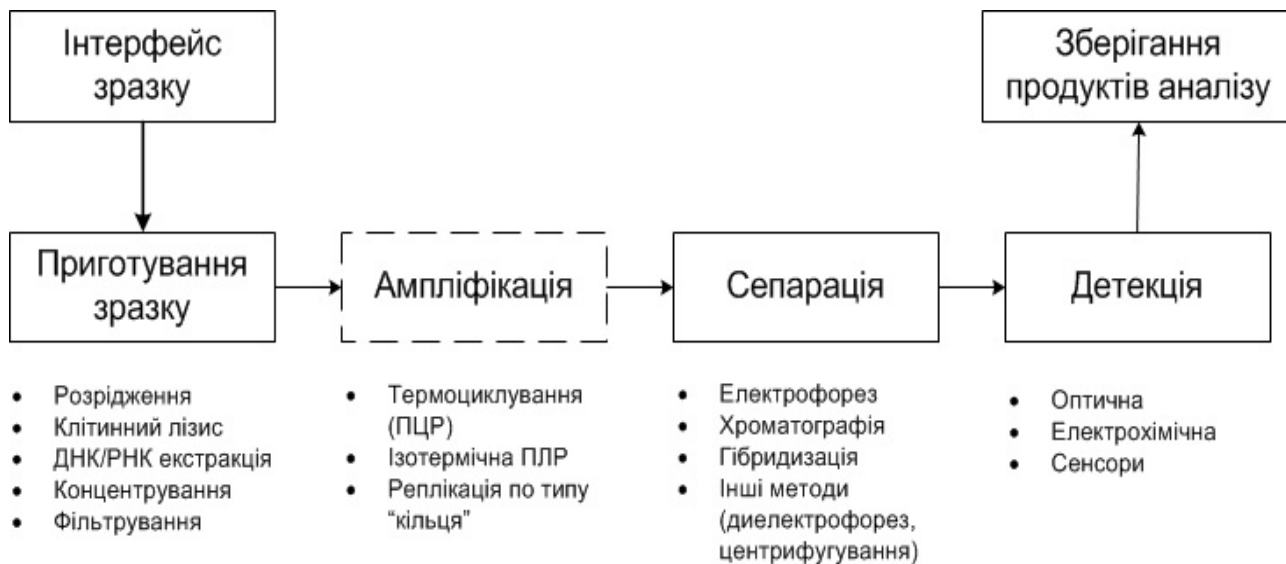
Рис. 1.7. Структурна схема типового діагностичного процесу для PMST.
