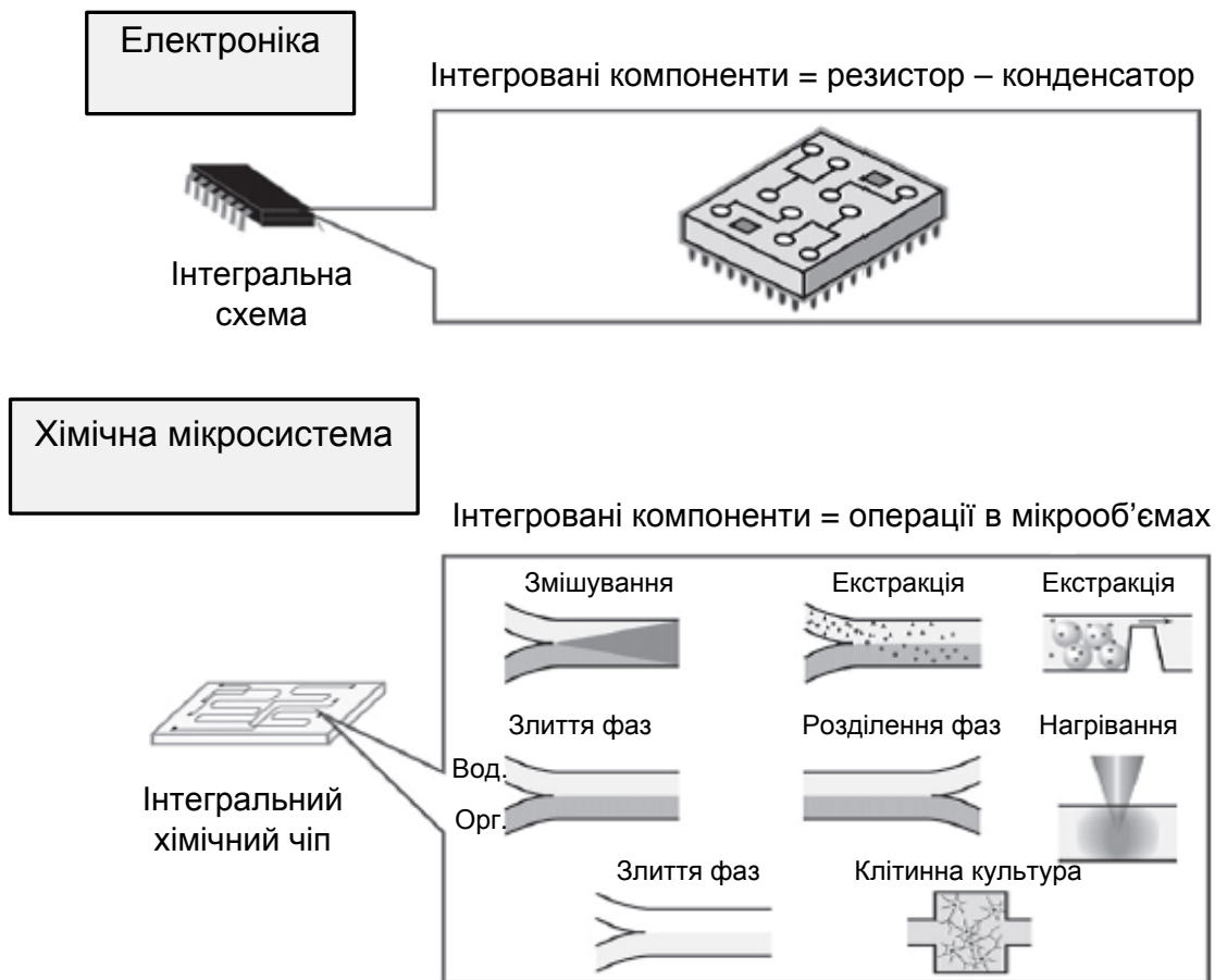
Рис. 1.2. Аналогія мікропотоків та мікроелектронних пристроїв.
