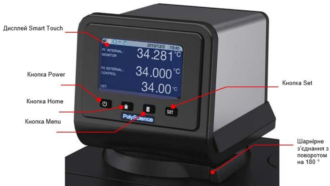
Рис. 1.2 Передня панель контролера AP15R-30
