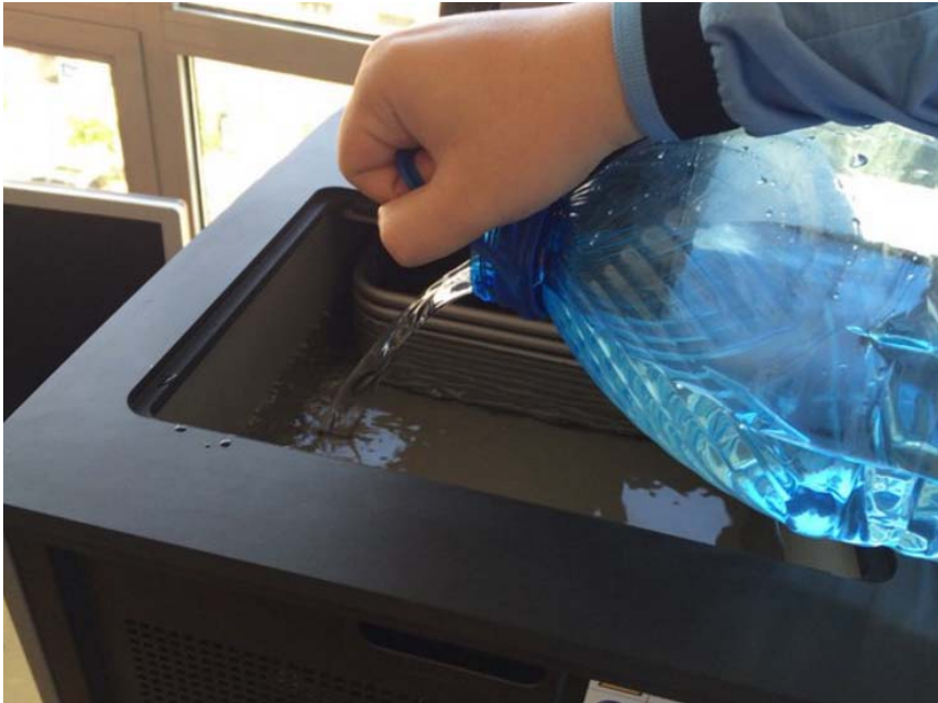
Рис. 1.5 Наповнення резервуару термостата водою
