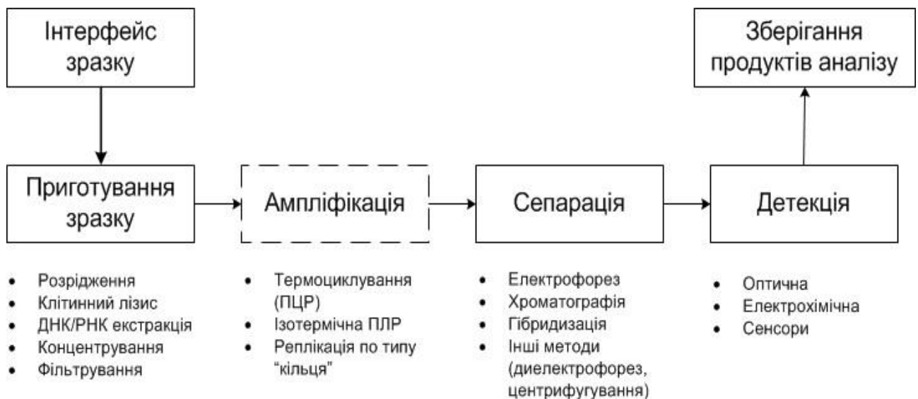
Рис. 1.7. Структурна схема типового діагностичного процесу для PMST.
