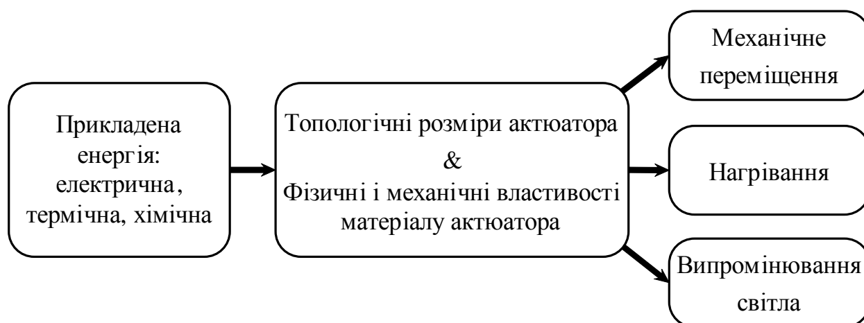
Рис. 8.1. Перетворення вхідної енергії в роботу актюатора
