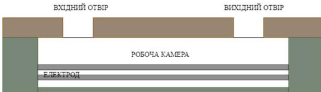
Рис. 8.46 Схематичне зображення електростатичної мікропомпи
