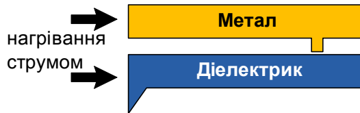
Рис. 8.11 Конструкція двошарового термоактюатора
