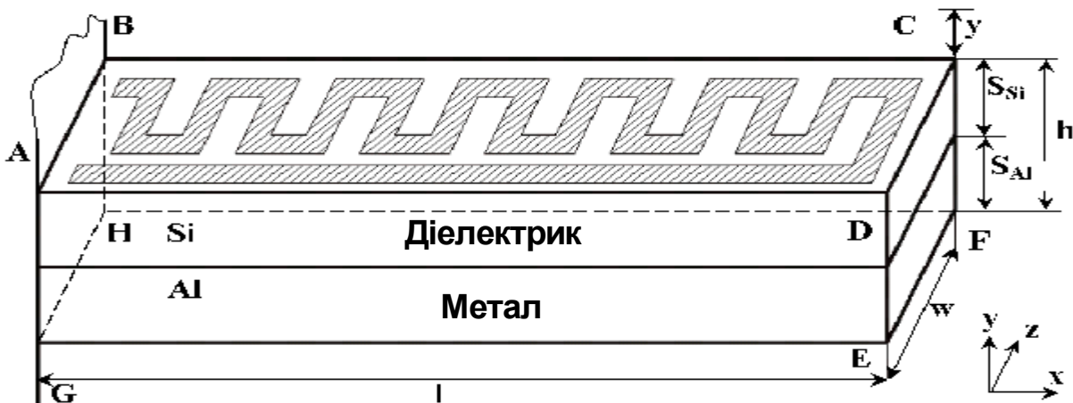
Рис. 8.12 Конструкція двошарового термоактюатора
