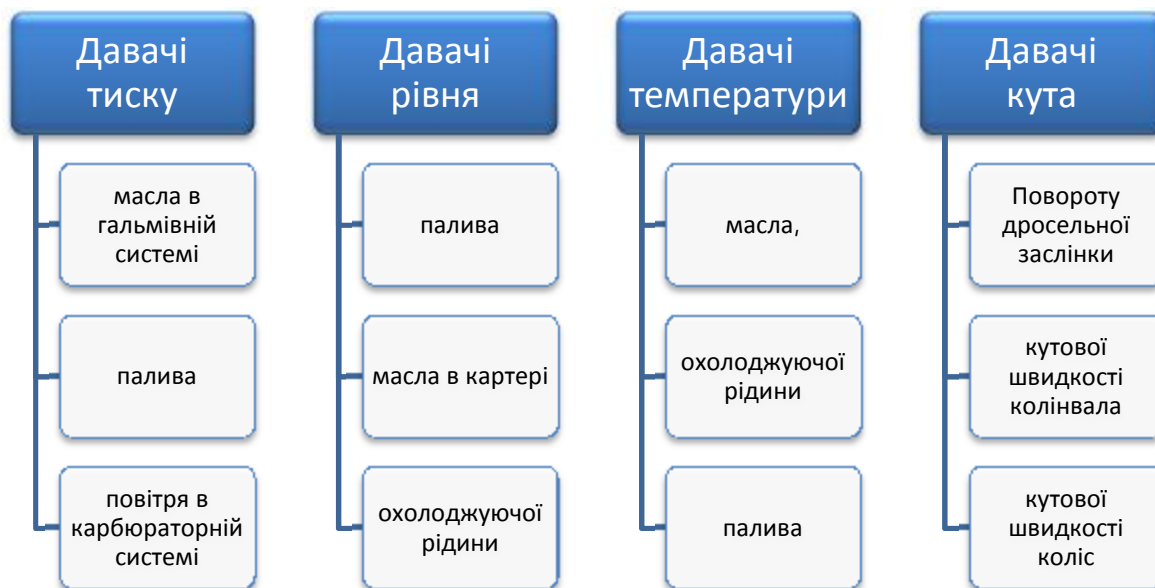
Рис. 1.4 Датчики, які використовують в сучасному автомобілі
