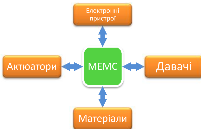
Рис. 3.2 Структура компонентів мікроелектромеханічних систем
