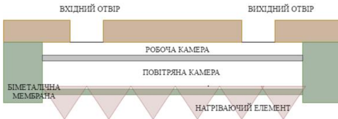
Рис. 8.48 Схематичне зображення конструкції термопневматичного мікронасоса
