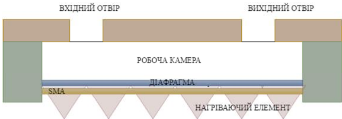
Рис. 8.49 Схематичне зображення конструкції мікропомпи з ефектом пам'яті
