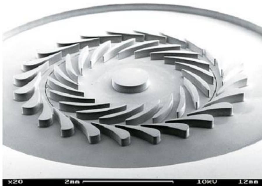
Рис. 8.13 Ротор мікротурбіни діаметром 4 мм [124]
