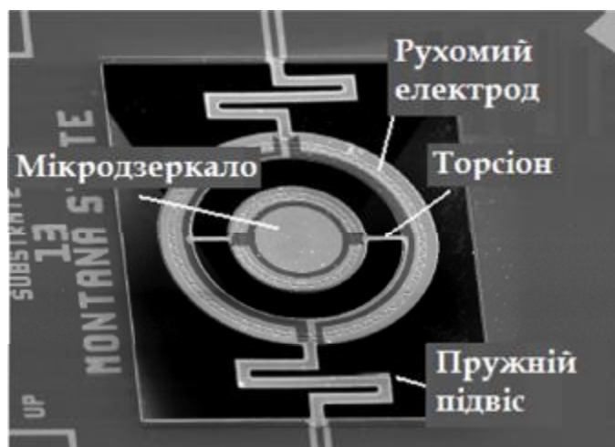
Рис. 8.25 Інтегральне двоосне дзеркало, виготовлене за технологією об'ємної мікрообробки
